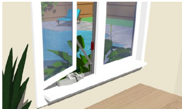
Figure 3 - Limiteur d'ouverture pour fenêtre, empêchant le passage d'un objet sphérique d'un diamètre supérieur à 10 cm
